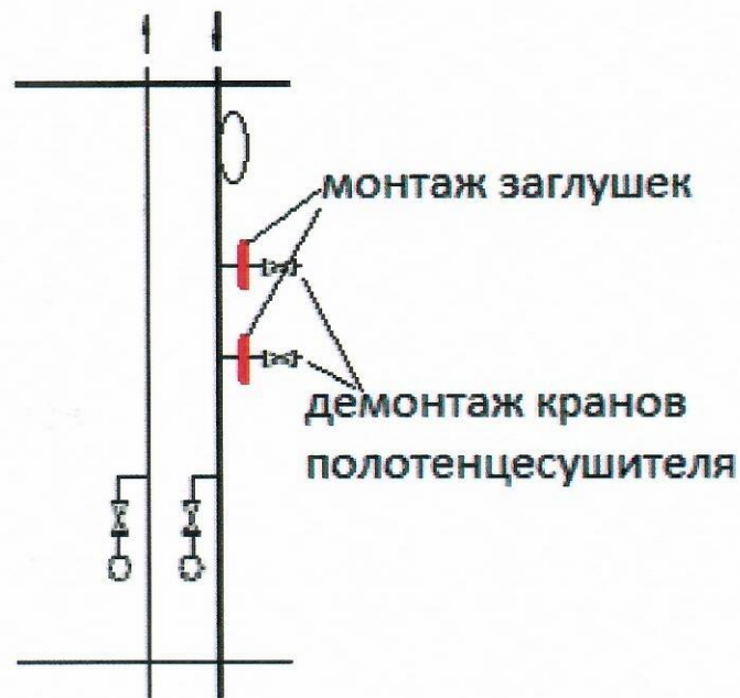
схема демонтаж/ монтаж сан.узел 2
